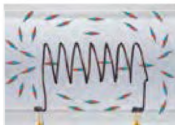
Rys. 3.4. Badanie pola magnetycznego zwojnicy z prądem za pomocą igieł magnetycznych
