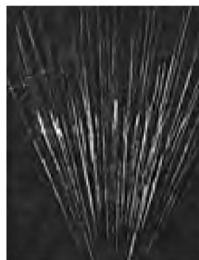
Rys. 40.4. Ślady \alpha -cząstek w urządzeniu rejestrującym cząsteczki naładowane (komora Wilsona)
