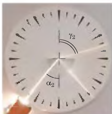
Rys. 12.5. Przy padaniu światła ze szkła do powietrza, w przypadku zwiększenia kąta padania, kąt załamania zbliża do 90^\circ , jasność światła zmniejsza się
