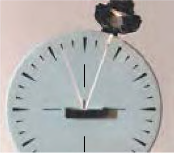
Rys. 11.3. Wraz ze zmianą kąta padania światła, zmienia się kąt odbicia. Kąt odbicia jest zawsze równy kątowi padania
