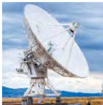
Rys. 21.3. Promieniowanie wąskiej skierowanej wiązki ultrakrótkich fal radiowych i odbieranie odbitego sygnału zabezpiecza paraboliczna antena radaru
