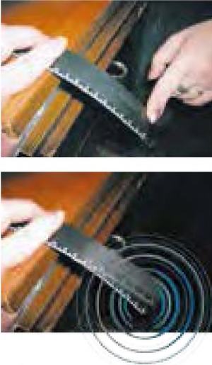
Rys. 18.1. Po odpuszczeniu końców linijki zaczyna ona drgać i wydawać dźwięki
