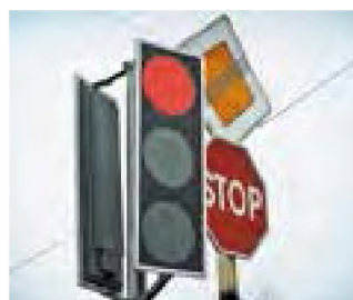
Rys. 9.3. Sygnał współczesnych świateł dobrze widać nawet wtedy, gdy bardzo jasno świeci słońce. Takie światła zawierają lamy LED
