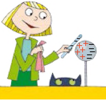
Rys. 5.1. Na skutek działania pola elektrycznego ujemnie naładowanej pałeczki bliższa do niej część sfery przewodzącej uzyskuje ładunek dodatni
