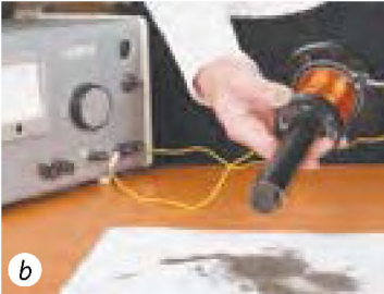
Rys. 6.4. Gdy obwód zamknijemy, wiórki żelazne przyciągną się do rdzenia (a); po rozłączeniu – odpadną (b)
