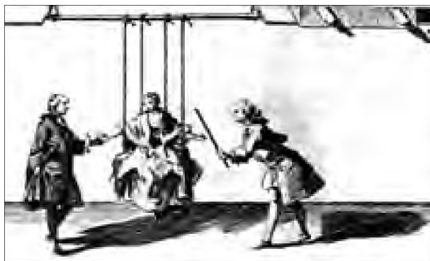
Rys. 40.6. Doświadczenie, które ilustruje istnienie przewodników i dielektryków (rycina śr. XVIII w.) kobieta siedzi na huśtawce, zawieszanej na jedwabnych sznurach. Człowiek, stojący z prawej przybliża do ręki kobiety naelektryzowaną szklaną pałeczkę, a stojący z lewej, dotyka jej drugiej ręki – pojawia się iskra
