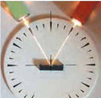
Rys. 11.5. Ilustracja odwracalności promieni świetlnych: promień odbity idzie drogą promienia padającego
