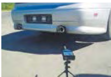
Rys. 5. Mierzenie poziomu hałasu tłumika samochodu
