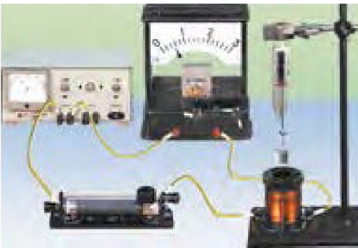
Rys. 6.1. Badanie działania magnetycznego zwojnicy z prądem
