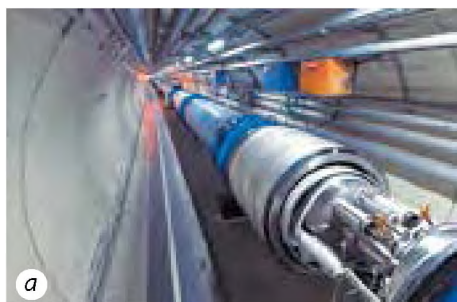
Rys. 22.1. Największe na dzień dzisiejszy urządzenie badawcze – to przyspieszacz cząstek naładowanych, którego pierwsze uruchomienie odbyło się w 2008 r.: a – wygląd wewnętrzny; b – wygląd schematyczny. Zdziwiający wymiary tego przyspieszacza: cząstki elementarne rozpędzają się w dużym pierścieniu o długości 26 km. Takie чудо techniki zostało zbudowane wspólnymi siłami wielu państw Europy
