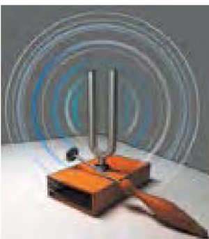
Rys. 18.2. Widelki kamertonu drgają i dlatego wydają dźwięki
