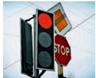
Fig. 9.3. Semnalele semafoarelor moderne sunt clar vizibile. Semnale luminoase moderne sunt clar vizibile chiar și atunci, când soarele strălucește puternic. În astfel de semafoare becurile incandescente sunt înlocuite cu becuri cu LED-uri
