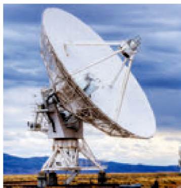
Fig. 21.3. Radiația fascicului direcționat îngust de radiunde ultracurte și recepția semnalului reflectat este asigurată de antena parabolică a radiolocatorului
