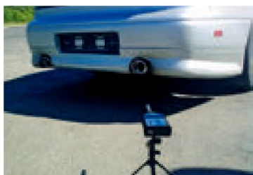
Fig. 5. Măsurarea nivelului zgomotului de la țeava de evacuare a automobilului
