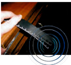
Fig. 18.1. După ce capătul riglei i se va da drumul, rigla va începe să oscileze și să emită sunet
