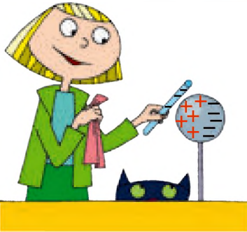
Fig. 5.1. În urma acțiunii câmpului electric al unui bastonaș încărcat negativ partea mai apropiată a unei sfere conductoare obține sarcină pozitivă
