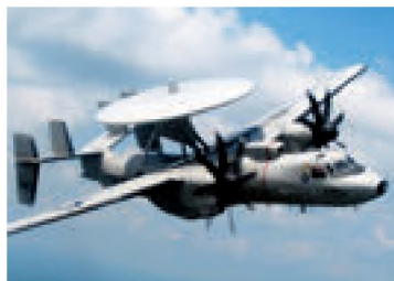
Fig. 21.4. «Radarul zburător» modern poate depista avionul inamicului la distanța de 540 km
