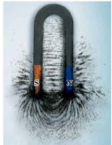
Fig. 2.4. Imaginea, creată de lăntșorul de pilitură de fier, creează tabloul liniilor inducției magnetice ale câmpului magnetic al magnetului în formă de potcoavă
