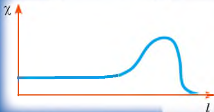
Fig. 3. Reprezentarea schematică a dependenței gradului de leziune a țesutului ( X ) de adâncimea parcursului ( l )
