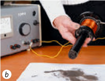
Fig. 6.4. După închiderea circuitului pilitura de fier este atrasă de miez (a); după deschidere – cad (b)
