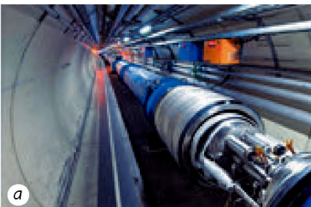
Fig. 22.1. Cea mai mare instalație de investigație la ora actuală – acceleratort de particule încărcate, primul demaraj al căruia a avut loc în a. 2008: a – aspectul interior; b – reprezentarea schematică. Uimesc dimensiunile acestui acceleratort: particulele elementare își iau viteza într-un inel imens cu lungimea de 26 km. Țările din Europa au fost nevoite să-și îmbine eforturile sale pentru a construi acest miracol al tehnicii
