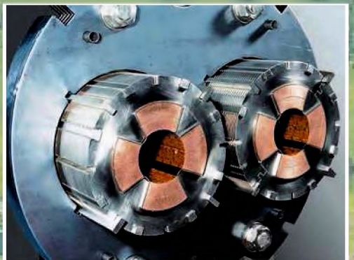
2. ábra. A töltött részecskét a gyorsító belsejében tartó szupererős mágnesek
