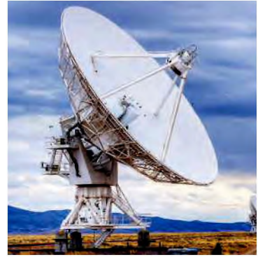
21.3. ábra. Az ultrarövid rádióhullámok keskeny irányított nyalábjának a sugárzását és a visszaverődött jel felfogását a radar parabola-antennája végzi
