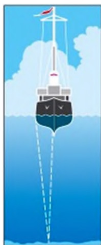
18.9. ábra. Vizmélység mérése echolokáció segítségével
