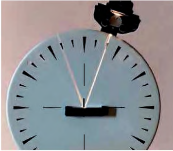
11.3. ábra. A beesési szög megváltozásával megváltozik a visszaverődési szög is. A két szög minden esetben egyenlő
