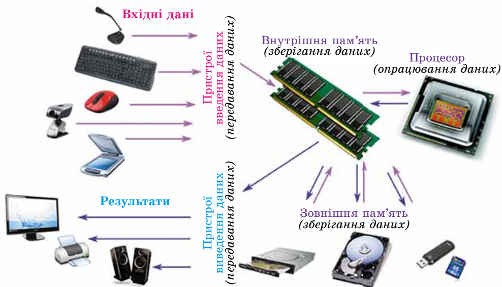
Мал. 2.1. Схема реалізації інформаційних процесів у персональному комп'ютері.
