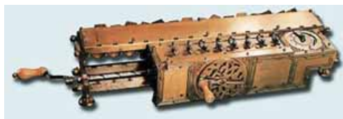
Рис. 2.25. Арифмометр Готфрида Лейбница
