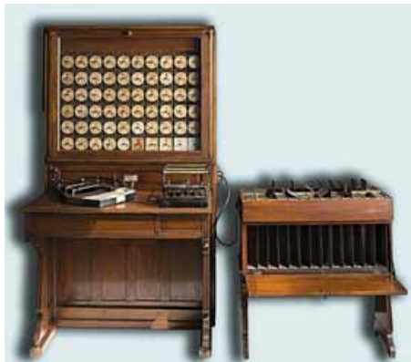
Рис. 2.29. Табулятор Германа Холлерита
