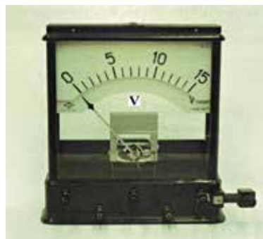
Рис. 125. Шкільний демонстраційний вольтметр
