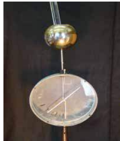
Рис. 91. а. Стрілка електрометра відхилена на однакові кути
