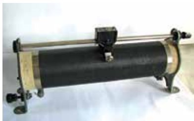
Рис. 131. Повзунковий реостат з ковзаючим контактом
