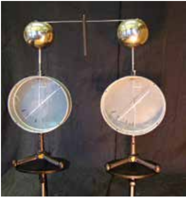
Рис. 89 а. Заряджений електрометр 1 з'єднали за допомогою металевої палички, закріпленої на пластмасовій ручці, з таким самим електрометром 2
