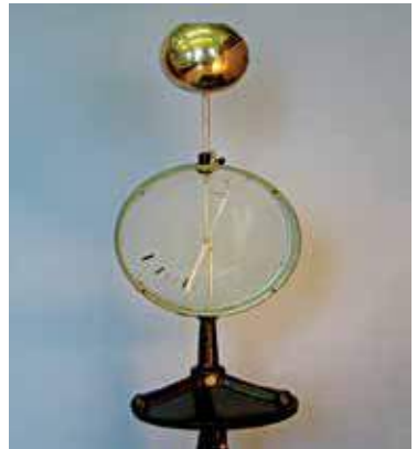
Рис. 88. Більш складний електроскоп-електрометр
