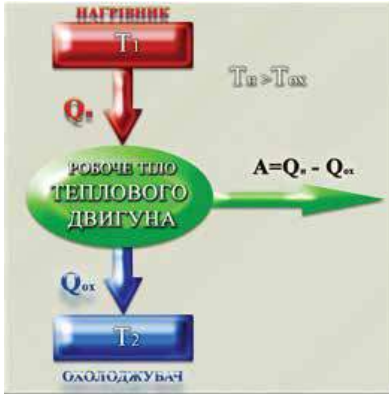
Рис. 73. Принцип дії теплового двигуна: робоче тіло отримує енергію від нагрівника, здійснює роботу і повертається у вихідний стан, віддаючи деяку кількість теплоти холодильнику
