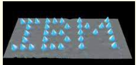
Рис. 45. Логотип компанії IBM викладений окремими атомами з використанням нанотехнологій
