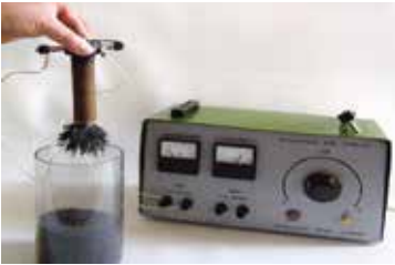
Рис. 106, б. Мідний ізолюваний провід намотати на залізний цвях і з'єднати з джерелом струму.
