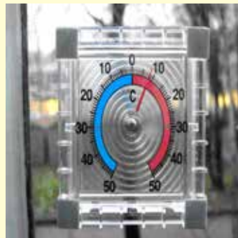
Рис. 12. Біметалічний вуличний термометр
