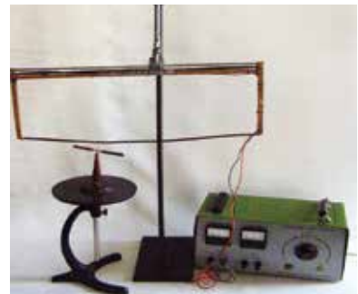
Рис. 106, а. Магнітна стрілка відхиляється від початкового положення, коли над нею (або поруч) по провіднику проходить електричний струм
