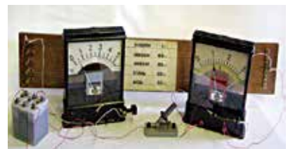
Рис. 130. Установа для визначення залежності опору провідника від його характеристик.
