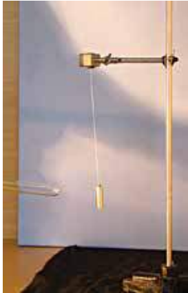
Рис. 84 а. Циліндрик відштовхується від палички, відхиляється на деякий кут і залишається у такому положенні.
