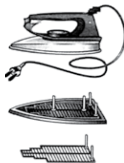
Рис. 149. Конструкція нагрівального елемента (ніхромова стрічка)
