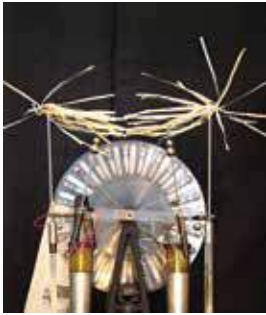
Рис. 100, а. Два султани, заряджені почергово різноіменними зарядами.
