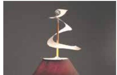
Рис. 50. Внаслідок конвекції теплий потік повітря від нагрітої лампи розжарення обертається паперова стрічка
