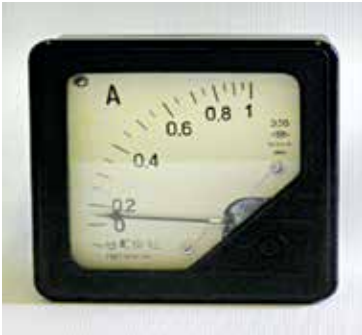
Рис. 123. Шкільний демонстраційний амперметр
