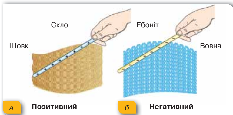
Мал. 77. Знаки зарядів під час електризації: а — позитивний на скляній паличці; б — негативний на ебонітовій
