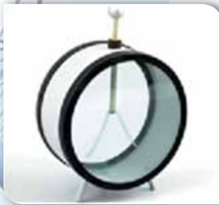
Мал. 99. Електроскоп: а — зовнішній вигляд; б, в — механізм електризації; г — принцип дії
