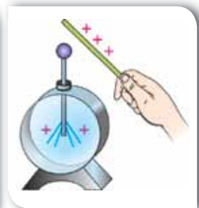
Мал. 99. Електроскоп: а — зовнішній вигляд; б, в — механізм електризації; г — принцип дії
