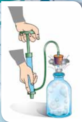
Мал. 26. Дослід із зменшення внутрішньої енергії повітря, за рахунок виконання ним роботи
