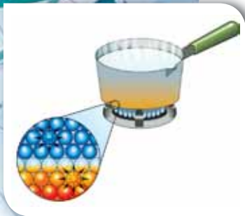
Мал. 29. Механізм теплопровідності
