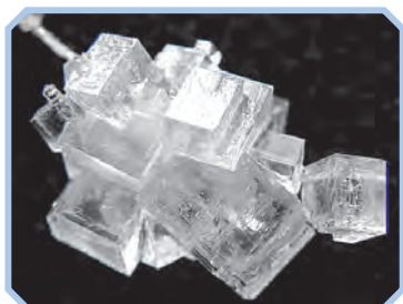
Рис. 38. Кухонна сіль — натрій хлорид — теж йонний кристал. Кристали цієї солі мають кубічну будову
