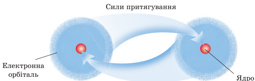
Рис. 15. Притягування електронної орбіталі ядром іншого атома
