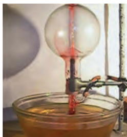
Рис. 5. Розчинення хлороводню у воді (дослід «Фонтан»)
