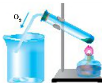
Рис. 38. Збирання кисню витискуванням повітря
