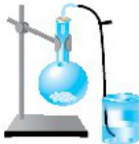
Рис. 51. Добування вуглекислого газу та пропускання його через розчин кальцій гідроксиду
