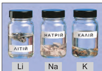
Rys. 3. Tak przechowuje się metale alkaliczne
