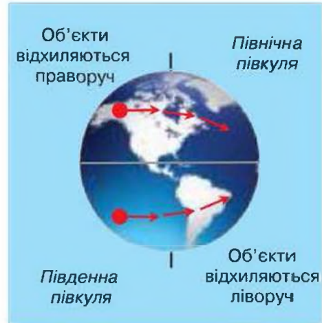
Мал. 7. Дія сили інерції — сили відхилення
