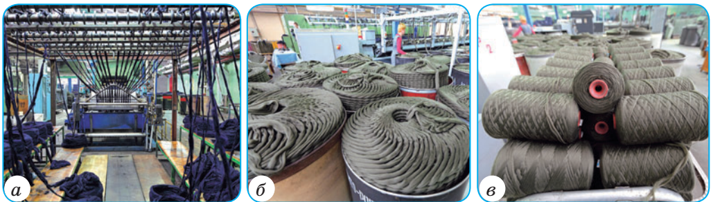
Мал. 15. Робота на рівничній машині (а, б) та готова до прядіння рівниця (в)
