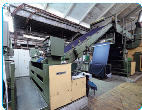
Мал. 18. Декатирування та сушіння тканини
