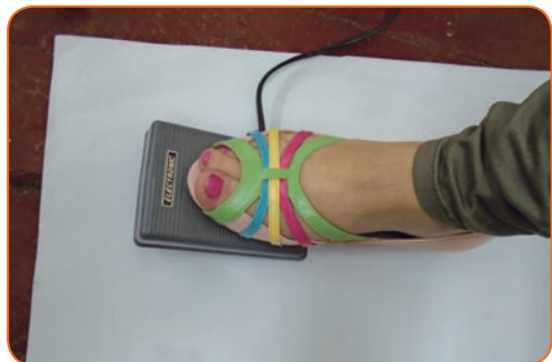
Мал. 163. Положення ноги під час роботи на швейній машині з електроприводом за допомогою пускорегулювальної педалі
