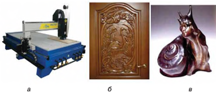
Мал. 98. Фрезерний верстат з комп'ютерним управлінням, що формує фрезою малюнок на поверхні деревини:
