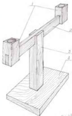
Мал. 48, а. Підсвічник, загальний вигляд: 1 — тримач для свічки; 2 — коромисло; 3 — стійка; 4 — основа
