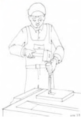
Мал. 78. Положення тіла при виконанні операції довбання гнізд та провущин
