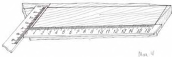
Мал. 41. Попереднє вимірювання заготовки слід проводити у місцях її найменших габаритних розмірів
