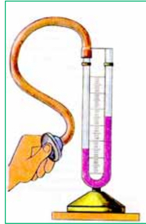
Рис. 3.72. Дія рідинного манометра
