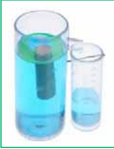
Рис. 3.77. Коли тіло плаває у рідині, то вага витісненої ним рідини дорівнює вазі цього тіла в повітрі
