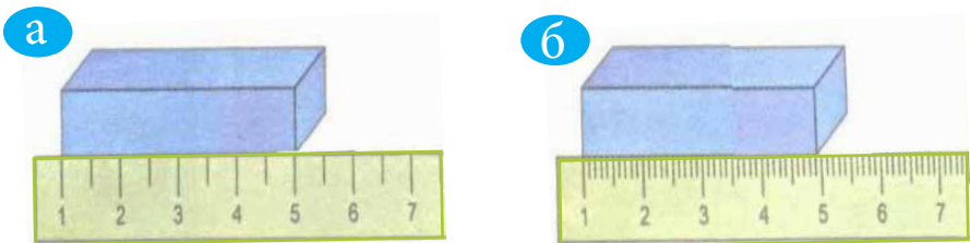
Рис. 1.30. Вимірювання довжини бруска лінійками, шкали яких мають різну ціну поділки
