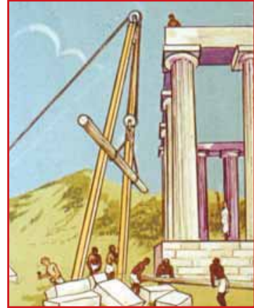
Рис. 4.13. Прості механізми дозволяють змінювати напрям дії сили на зручніший для людини
