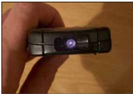
Рис. 1.14. Інфрачервоне випромінювання пульта дистанційного керування, зняте цифровою відеокамерою
