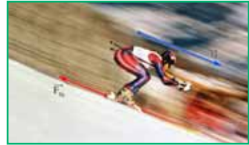
Рис. 3.40. Сила тертя ковзання напрямлена вздовж поверхонь дотику тіл протилежно до швидкості їх руху
