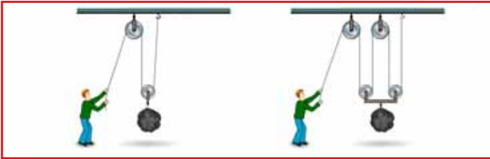
Рис. 4.31. Зазвичай на практиці використовують комбінацію рухомого і нерухомого блоків
