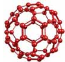
Рис. 1.18. Розмір фулеренів (модифікація молекул вуглецю) не перевищує один нанометр ( 1 \text{ нм} = 10^{-9} \text{ м} )
