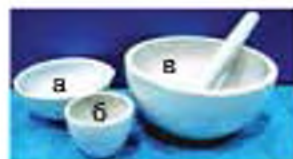
Мал. 12. Порцеляновий посуд: а — чашка; б — тигель; в — ступка з товкачем
