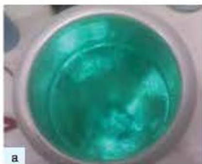
Мал. 79. Рідкий кисень (а) та балони зі стисненим киснем(б)
