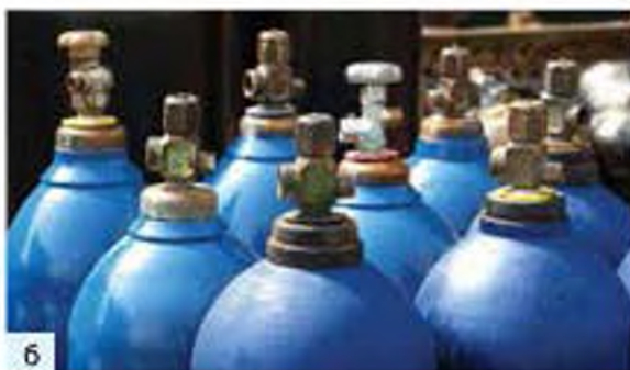
Мал. 79. Рідкий кисень (а) та балони зі стисненим киснем(б)
