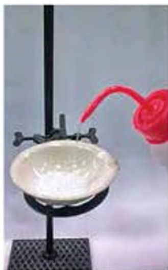
Мал. 70. Виділення теплоти у реакції кальцій оксиду з водою
