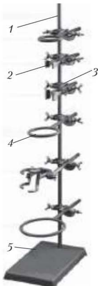
Рис. 19. Будова лабораторного штатива:
