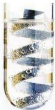
Рис. 54. Утворення пухирців водню на цинковій пластинці
