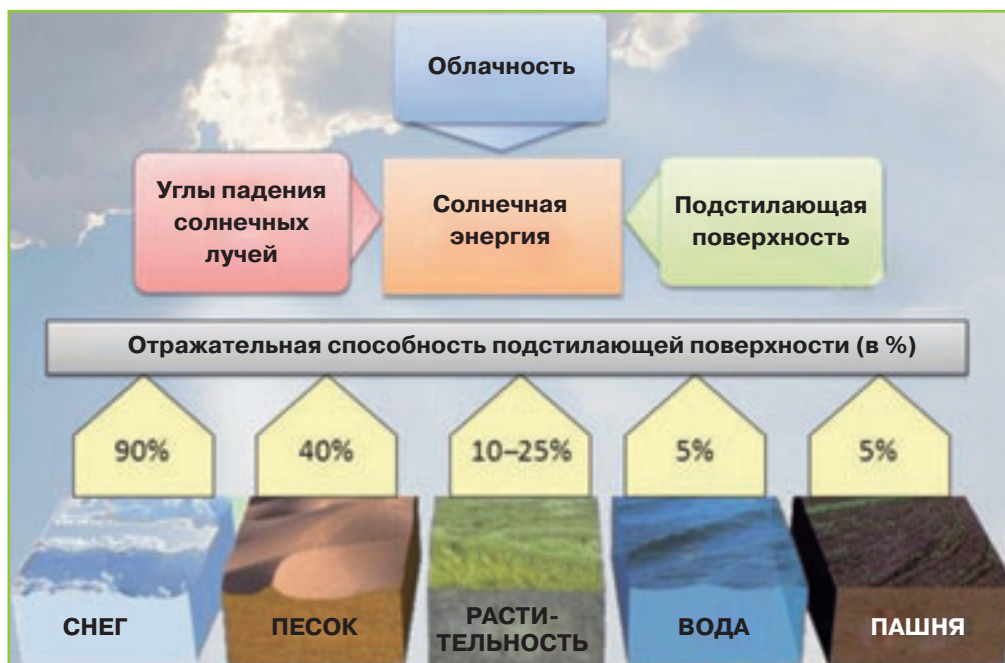
Рис. 14. Способность разных поверхностей отражать солнечную энергию
