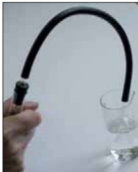
Рис. 59. Проверка прибора на герметичность
