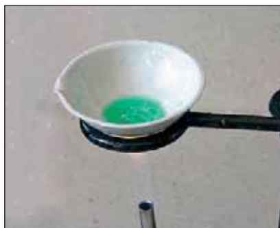
Рис. 21. Нагревание жидкости в фарфоровой чашке
