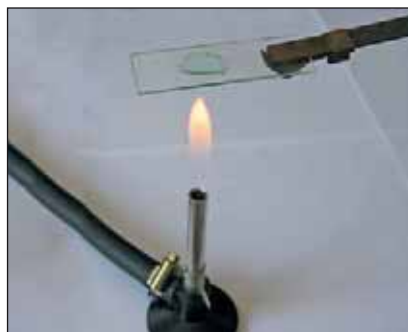
Рис. 22. Выпаривание жидкости на предметном стекле
