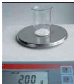
Рис. 79. Порция вещества, взвешенная на электронных весах
