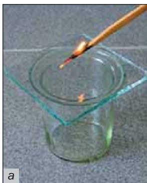
Рис. 53. Обнаружение кислорода: а — тлеющая лучинка на воздухе; б — возгорание лучинки в кислороде
