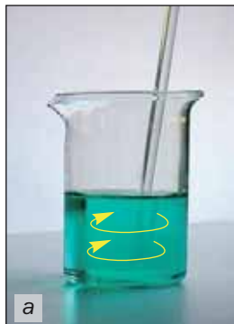
Рис. 16. Перемешивание жидкости: а — стеклянной палочкой; б — встряхиванием
