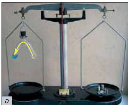
Рис. 52. Опыт, подтверждающий закон Ломоносова — Лавуазье: а — начало опыта; б — окончание опыта
