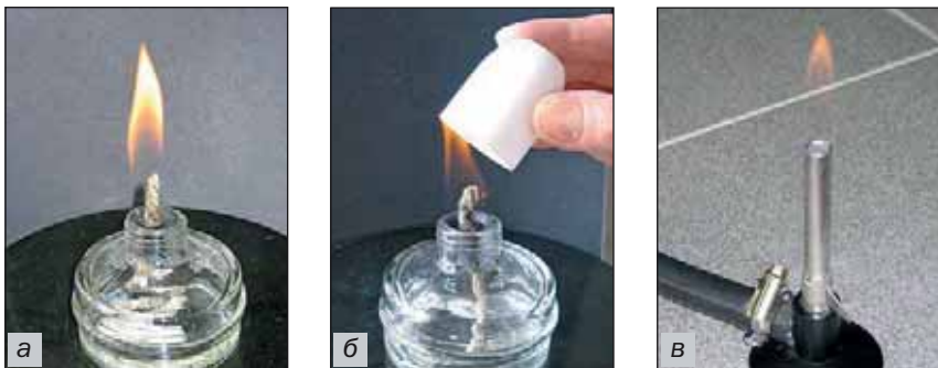
Рис. 13. Устройства для нагревания: а — спиртовка; б — гашение пламени колпачком; в — газовая горелка
