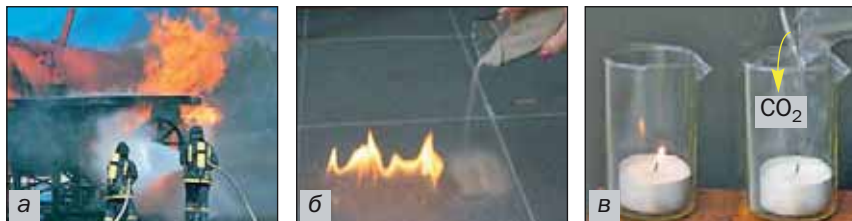
Рис. 64. Гашение пламени: а — водой; б — песком; в — углекис- лым газом
