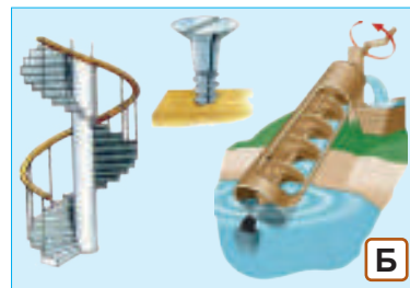
Мал. 11.6. Приклади простих механізмів: А — клин, Б — гвинти
