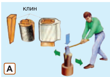
Мал. 11.6. Приклади простих механізмів: А — клин, Б — гвинти
