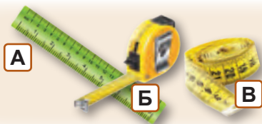
Мал. 2.1. Вимірювальні прилади: А — лінійка, Б — рулетка, В — мірна стрічка
