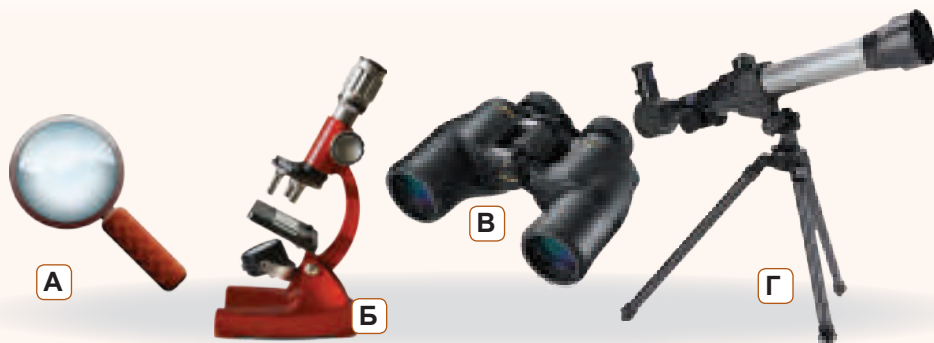
Мал. 2.4. Збільшувальні прилади: А — лупа, Б — мікроскоп, В — бінокль, Г — телескоп
