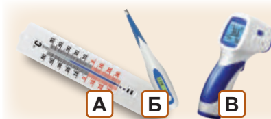
Мал. 2.2. Різні види термометрів: А — рідинний, Б — електронний, В — інфрачервоний (безконтактний)
