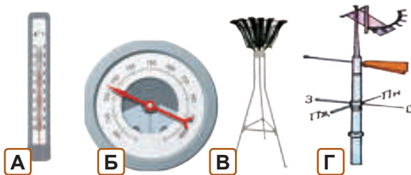
Мал. 19.1. Метеорологічні прилади: А — термометр; Б — барометр; В — опадомір; Г — флюгер
