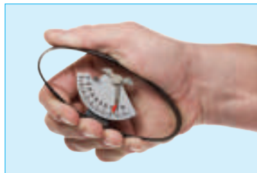
Мал. 10.3. Ручний динамометр «силомір»
