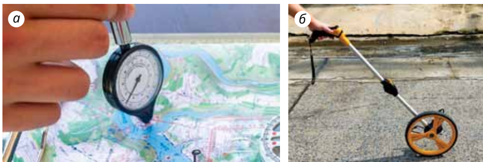
Мал. 4.3. Визначення курвіметром довжини кривих ліній: a — на карті; b — на місцевості
