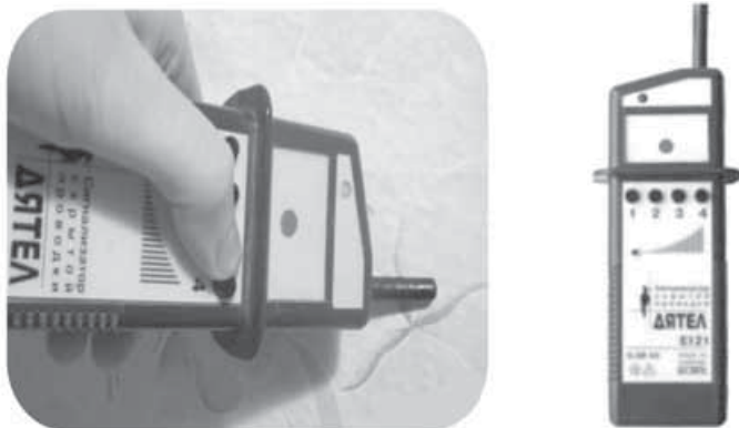
Мал. 117. Сигналізатор прихованої проводки E121 «Дятел»
