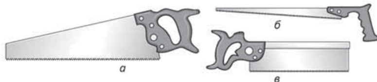
Мал. 36. Види ножівок: а – столярна; б – вузька; в – обушкова пилка
