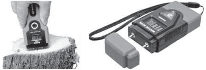
Мал. 9. Вимірювання вологості вологоміром
