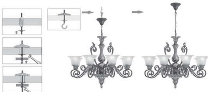
Мал. 124. Кріплення люстри пружинним дюбелем
