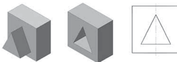
Мал. 17. Проєкція до двох деталей
