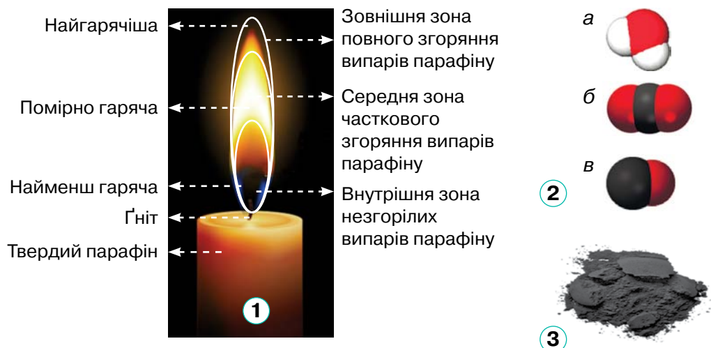
Мал. 5.3. 1. Зони полум'я. 2. Моделі молекул води (а), вуглекислого (б) й чадного (в) газів. 3. Кіптява — дрібні частинки вуглецю
