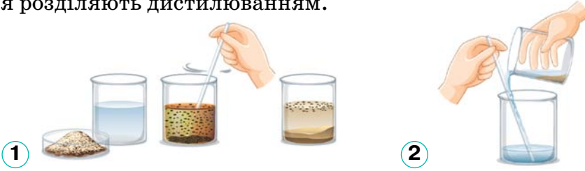
Мал. 12.2. 1. Відстоювання. Суспензія ґрунту із часом розшаровується. 2. Декантування. Воду обережно зливають, осад залишається
