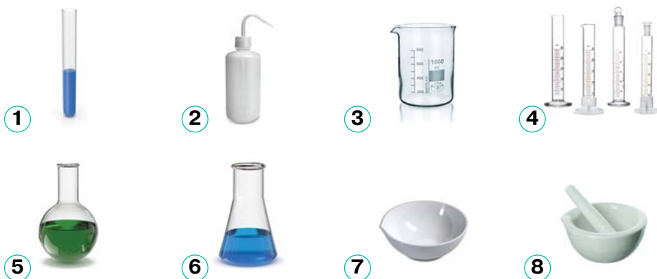
Мал. 2.2. Лабораторний посуд. 1. Пробірка. 2. Промивалка. 3. Хімічний стакан. 4. Мірні циліндри. 5. Круглдонна колба. 6. Конусоподібна колба. 7. Чашка для випарювання. 8. Ступка з товчачиком
