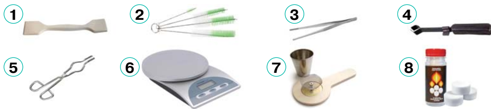
Мал. 2.3. Лабораторне приладдя. 1. Шпатель. 2. Йоржики. 3. Пінцет. 4. Тримач для пробірок. 5. Тигельні щипці. 6. Цифрові ваги. 7. Пальник для сухого палива. 8. Сухе паливо
