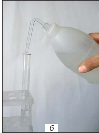
Мал. 10. Промивалка (а) і користування нею (б)
