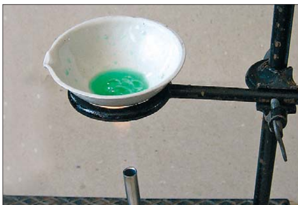
Мал. 26. Нагрівання рідини в порцеляновій чашці
