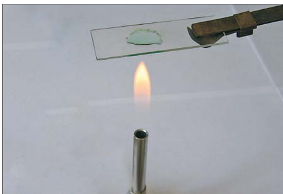
Мал. 27. Випарювання рідини на предметному склі
