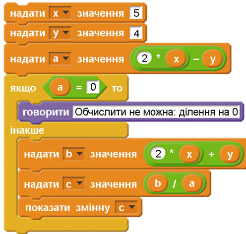
Мал. 4.18. Проєкт для обчислення значення виразу (2*x + y)/(2*x - y) у Scratch 2
