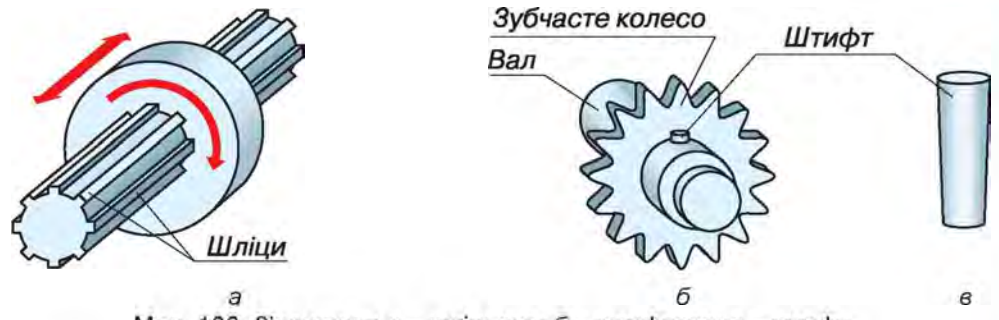
Мал. 189. З'єднання: а – шліцьове; б – штифтове; в – штифт
