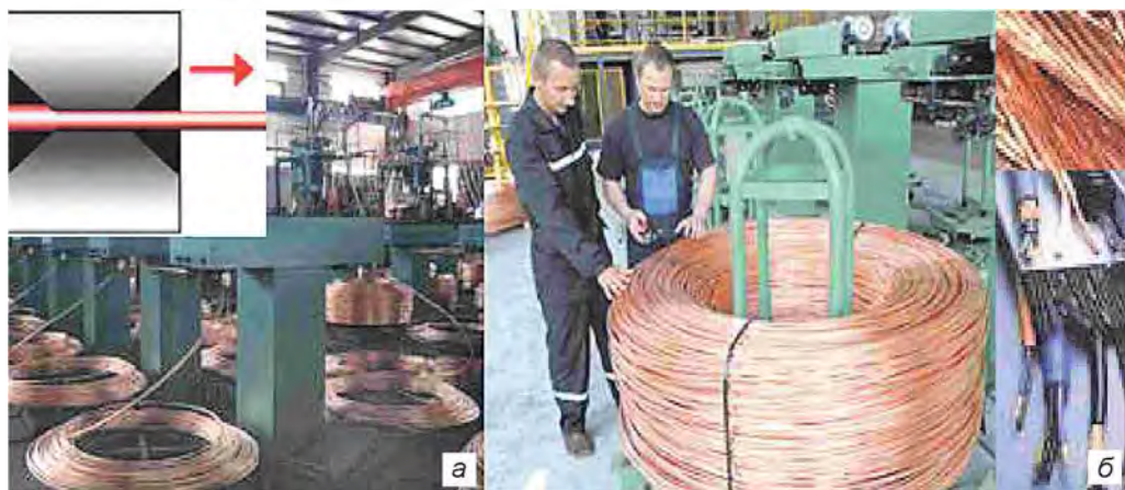
Мал. 35. Види одножильного та багатожильного мідного дроту: а – без ізоляційних оболонок; б – в ізоляційних оболонках
