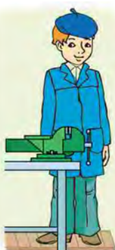
Мал. 11. Регулювання висоти слюсарного верстака ростовою підставкою
