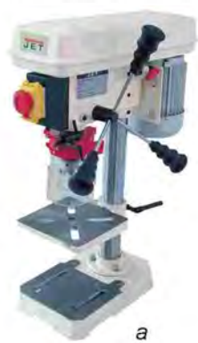
Мал. 206. Промислові свердлильні верстати: а – вертикально-свердлильний; б – радіально-свердлильний; в – настільний свердлильний
