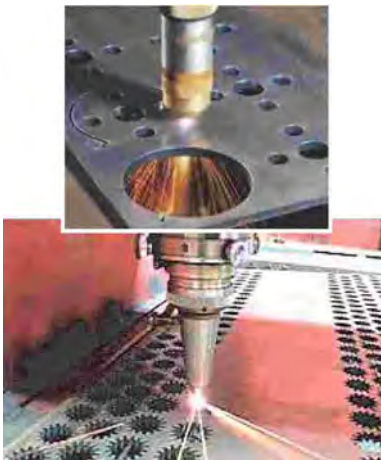
Мал. 84. Різання металу лазером
