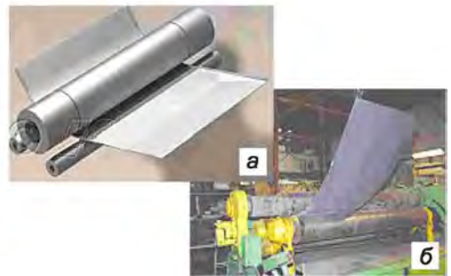
Мал. 59. Формування виробу вальцями: а – ручними; б – електромеханічними
