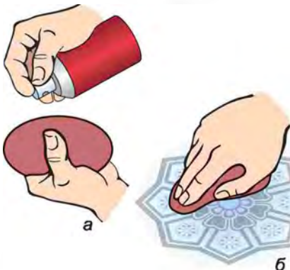
Мал. 159. Полірування тампоном: а – нанесення пасту; б – полірування
