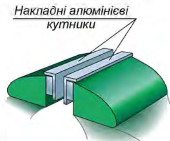
Мал. 6. Оснащення слюсарних лещат накладними кутниками
