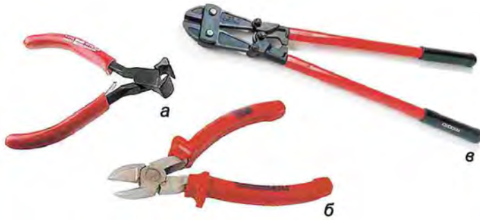
Мал. 132. Види кусачок для різання сталюого дроту: а – діаметром до 5 мм; б – діаметром до 3 мм; в – діаметром понад 8 мм
