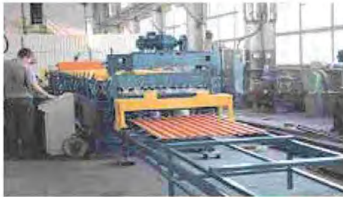
Мал. 111. Гнуття металу на профілезгинальному стані
