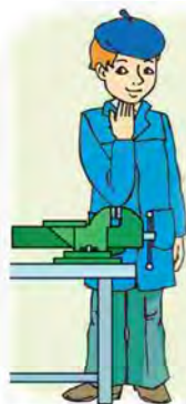
Мал. 10. Визначення відповідності висоти слюсарного верстака зросту працюючого
