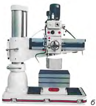
Мал. 206. Промислові свердлильні верстати: а – вертикально-свердлильний; б – радіально-свердлильний; в – настільний свердлильний
