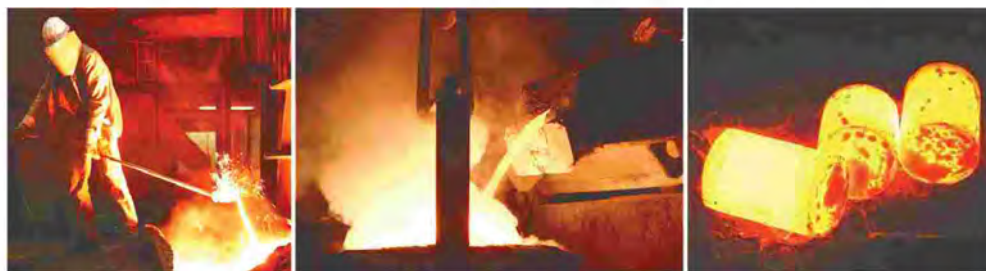
Мал. 25. Виплавлення заготовок сировини (зливків) з міді
