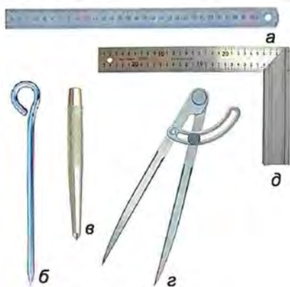
Мал. 61. Розмічальні слюсарні інструменти: а – масштабна лінійка; б – рисувалка; в – кернер; г – слюсарний циркуль; д – слюсарний кутник
