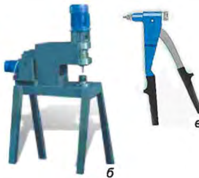
Мал. 126. Інструменти для клепаання: а – пневматичний клеपालний молоток; б – електромеханічна клеपालна машина; в – ручний заклепочник
