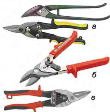
Мал. 70. Типи ножиць: а – прямолінійні; б – фігурні; в – універсальні
