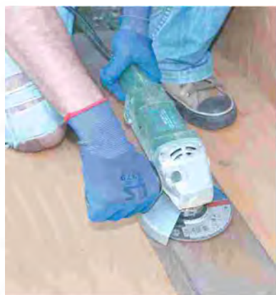
Мал. 154. Очищення від іржі електрифікованим інструментом
