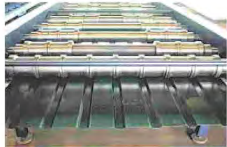
Мал. 111. Гнуття металу на профілезгинальному стані
