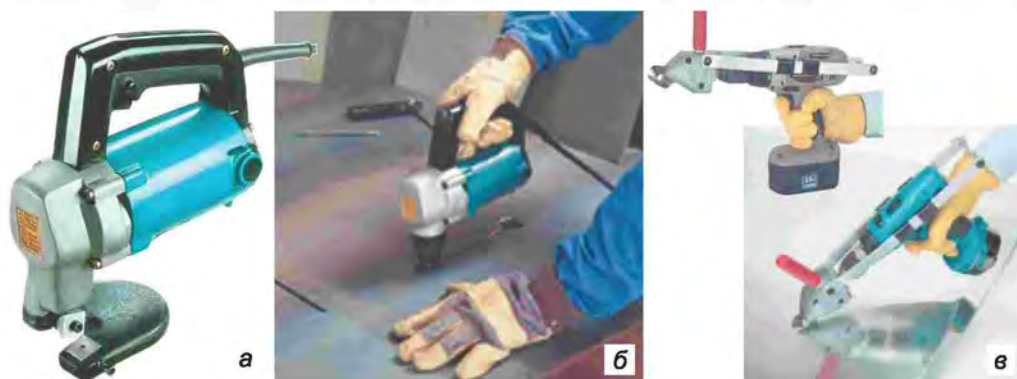
Мал. 80. Ручні електричні ножиці: а – загальний вигляд; б – прийом різання; в – насадка-ножиці
