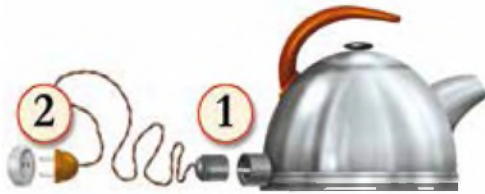
Мал. 51. Порядок вмикання електроприладу
