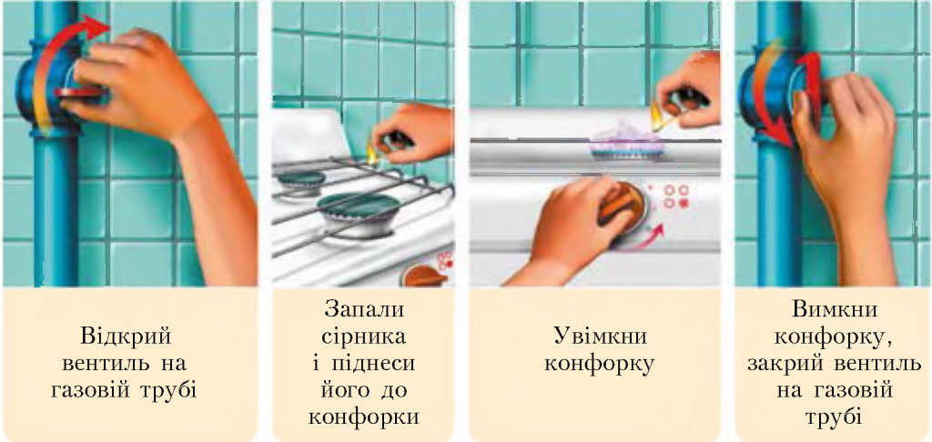
Мал. 52. Порядок вмикання і вимикання газової конфорки
