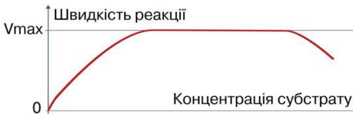
Рис. 8. Залежність швидкості реакції від концентрації субстрату
