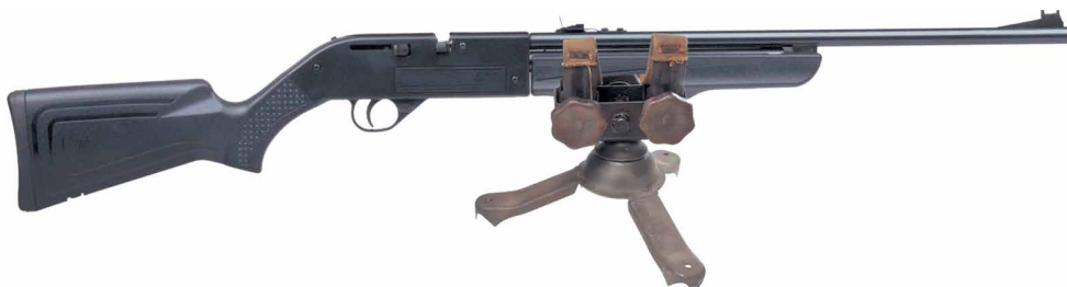
Мал. 13. Гвинтівка, закріплена у прицільному верстаті ПС-51
