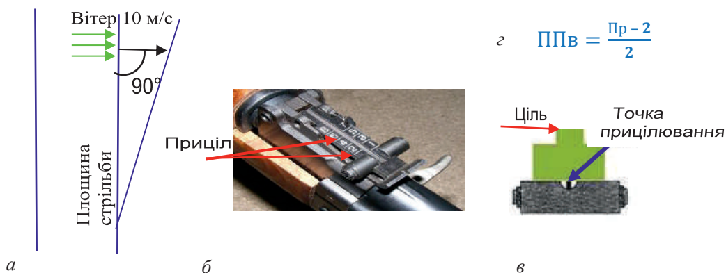
Іл. 1.9. Методика вибору абсолютного значення поправки (а) на бічний вітер під час прицілювання за допомогою прицільних пристроїв зброї (б, в) і формули (г)
