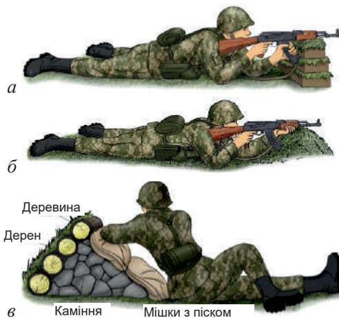
Іл. 1.5. Жорсткий упор для стрільби лежачи з упора: а — з дощок; б — із землі; в — з різних матеріалів
