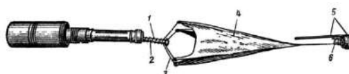
Іл. 3.7. Граната РКГ-3 під час польоту: 1 — пружина стабілізатора; 2 — рухома трубка; 3 — дротяні пир'їни; 4 — матер'яний конус; 5 — відкидний ковпак з планкою; 6 — пружина ковпака
