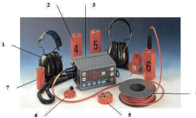
Іл. 34.5. Загальний вигляд геофона: 1 — навушники; 2 — датчики; 3 — пульт; 4 — котушка з кабелем; 5 — розгалуження; 6 — приймач речового сигналу; 6 — магніт
