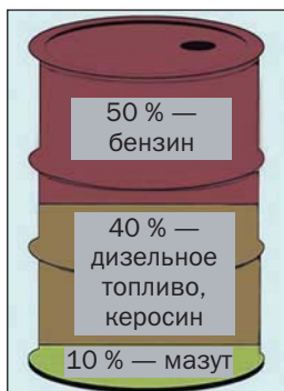
Рис. 26. Приблизительное распределение продуктов перегонки нефти по массе
