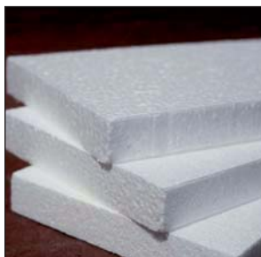
Рис. 86. Блоки из пенопласта для утепления зданий
