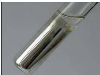
Рис. 45. Пробирка с «серебряным зеркалом»
