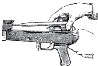
7. Відокремити затворну раму із затвором
