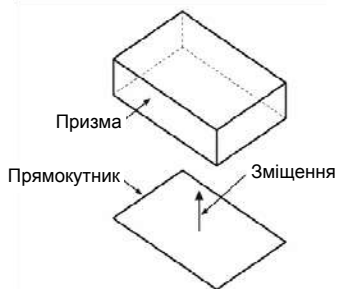
Принцип дії операції видавлювання
