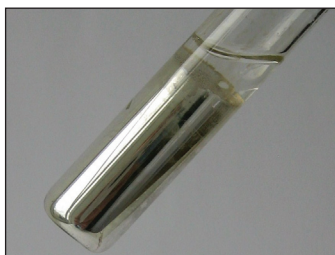
Fig. 45. Eprubeta cu „oglină de argint”
