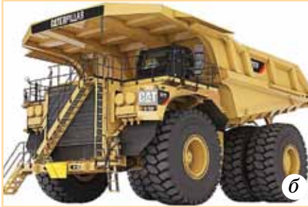
Мал. 56. Найбільші машини світу: а) гірничий комбайн німецької компанії «Rheinbraun»; б) кар'єрний самоскид «Caterpillar 797F»
