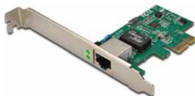
Мал. 2.2. Мережевий адаптер для кабельних мереж
