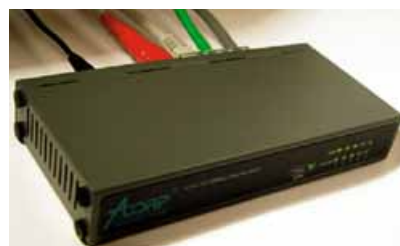
Мал. 2.3. Комутатор для кабельних мереж
