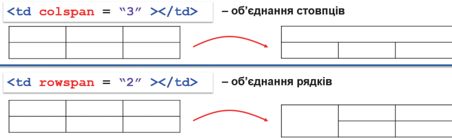
Рис. 27.2. Приклади об'єднання клітинок
