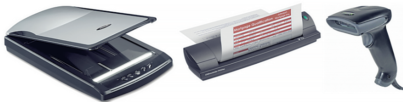
Рис. 8.2. Планшетний, листовий (протяжний), ручний сканери
