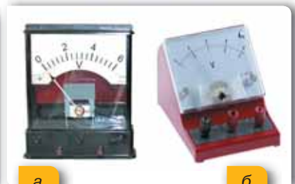
Мал. 148. Вольтметр: а — демонстраційний; б — лабораторний
