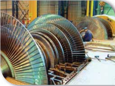
Мал. 69. Потужна промислова багатоступінчата турбіна виробництва «Турбоатом»
