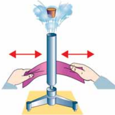
Мал. 25. Дослід зі збільшення внутрішньої енергії завдяки виконанню механічної роботи
