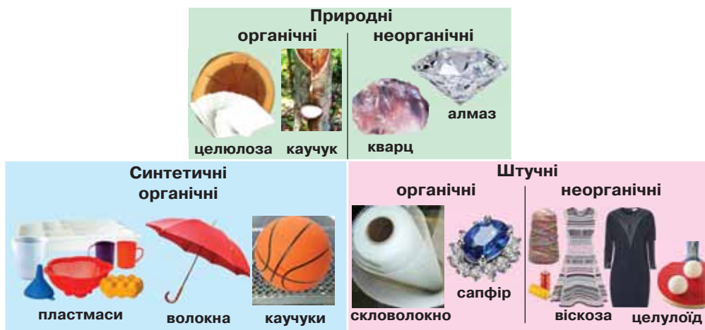
Мал. 81. Приклади полімерів і полімерних матеріалів
