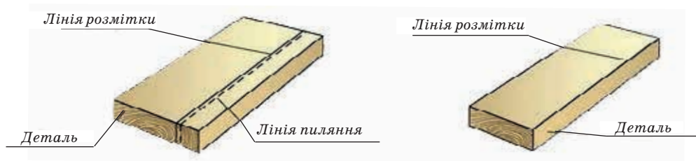
Мал. 24. Розпилювання заготовки
