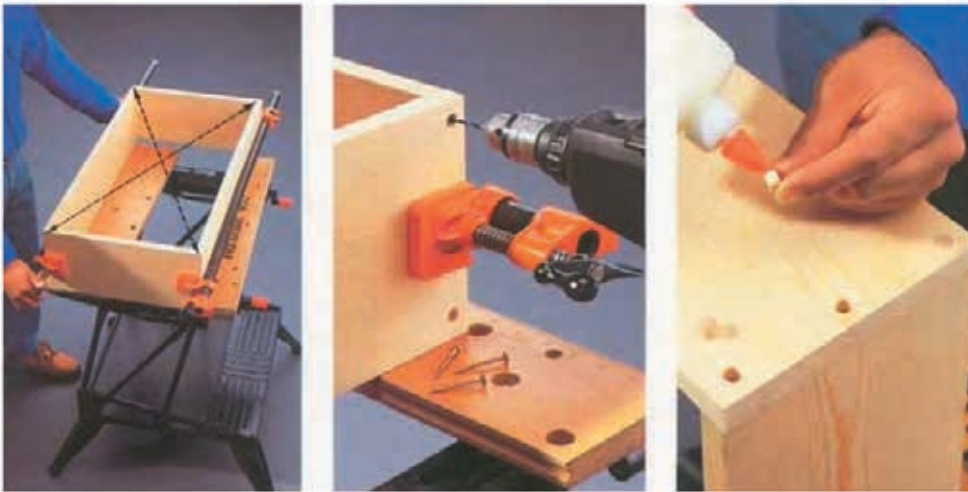
Мал. 39. З'єднання та склеювання деталей комплексного виробу
