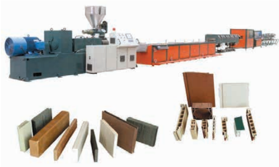
Мал. 4. Технологічна лінія виробництва деревно-полімерних композитів
