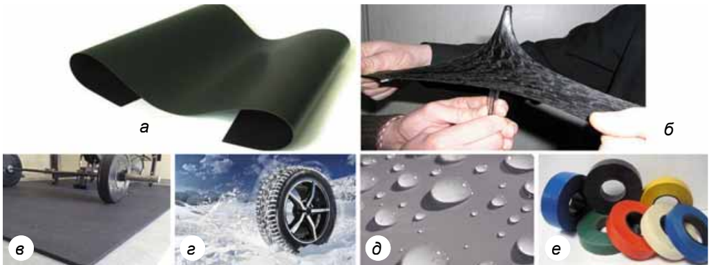
Мал. 10. Властивості гуми: а – еластичність; б – розтяжність; в – ударна стійкість; г – зносостійкість; д – вологостійкість; е – електроізоляційність
