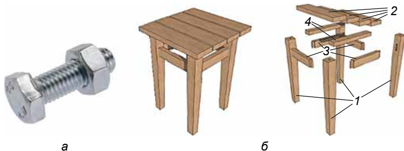
Мал. 29. Складальна одиниця: а – болтове з'єднання; б – табурет
