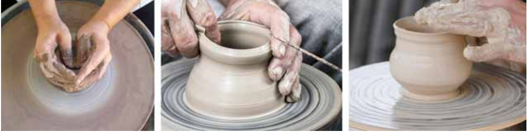
Мал. 148. Виготовлення виробу на гончарному крузі
