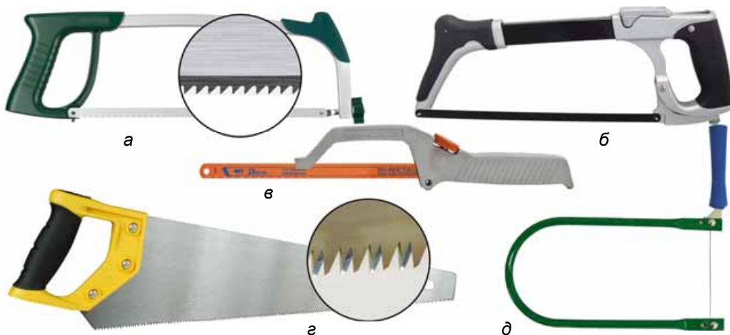
Мал. 42. Ножівки: для різання металу (а – проста; б – розсувна; в – мана-ножівка); для різання деревинних матеріалів (г – ножівка столярна дрібнозуба; д – лобзик)
