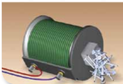
Мал. 41. Дослідження магнітної дії котушки залежно від наявності залізного осердя
