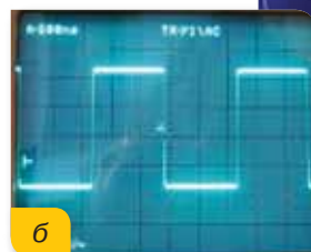
Мал. 168. Способи передавання сигналу: а — аналоговий; б — цифровий
