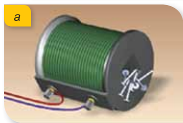
Мал. 40. Дослідження магнітної дії котушки залежно від сили струму в її витках
