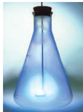
Рис. 46. Взаємодія сірки з киснем
