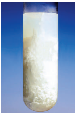
Рис. 39. Якісна реакція на хлорид-іон
