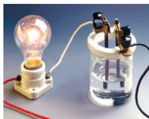
Рис. 27. Прилад для дослідження електропровідності речовин та їхніх розчинів
