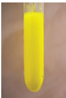
Рис. 43. Якісна реакція на ортофосфат-іон
