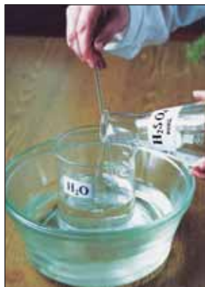
Мал. 9. Приготування розбавленого розчину сульфатної кислоти
