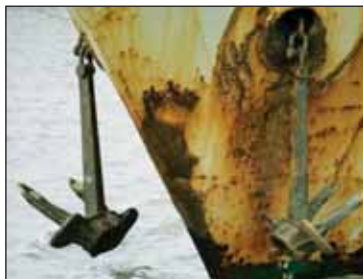
Мал. 32. Корпус судна, вкритий іржею
