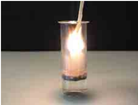
Мал. 34. Каталітичний розклад гідроген пероксиду \text{H}_2\text{O}_2
