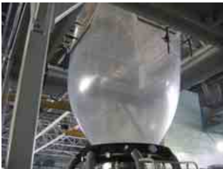
Мал. 51. Пакувальну плівку з поліетилену виготовляють витискуванням розплавленого полімеру крізь кільцевий отвір. У полімерну трубу накачують повітря
