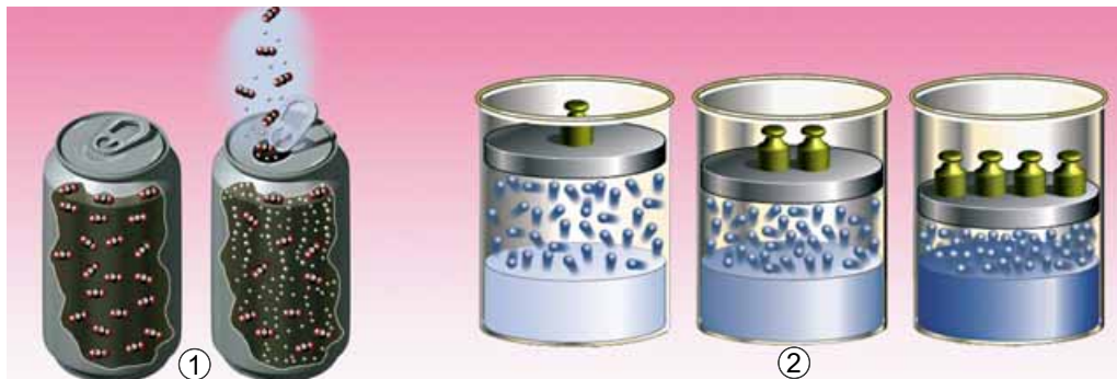
Рис. 7.3. 1. Зміни, які відбуваються під час відкорковування бляшанки з газованим напоєм. 2. Залежність розчинності газів від тиску. Завдання. Спробуйте пояснити, чому зі зростанням тиску розчинність газів збільшується
