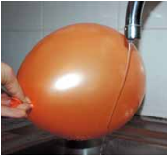
Рис. 6.3. Цівка води притягується до наелектризованого предмета. Завдання. Перевірте цю інформацію експериментально
