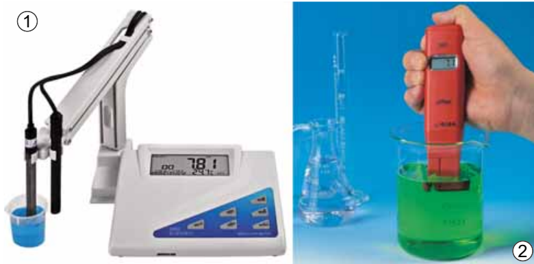
Рис. 14.2. рН-метри. 1. Стационарний. 2. Портативний
