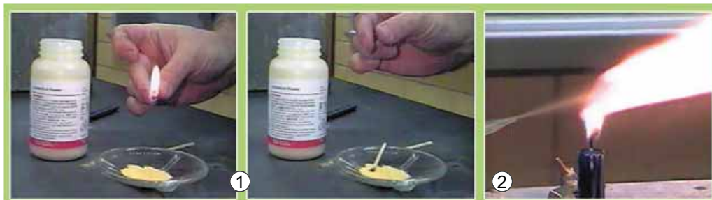
Рис. 20.6. Тонкодисперсний жовтий пилок спор плауна (лікоподій) застосовують у фармації для пересипання пігулок. Купку цієї речовини не завжди вдається підпалити сірником (1). Натомість розпорошений у повітрі лікоподій згоряє миттєво (2)
