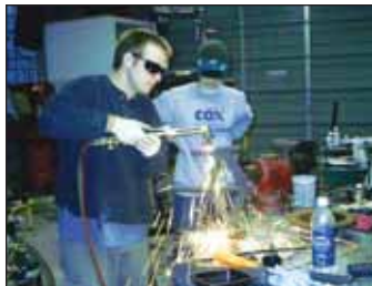
Рис. 67. Резка металла с помощью ацетиленовой горелки
