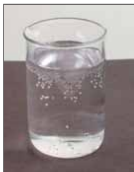
Рис. 14. Выделение пузырьков растворенного воздуха из нагретой водопроводной воды
