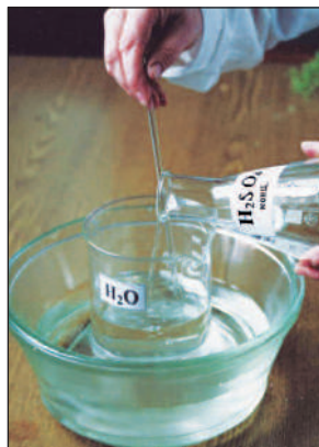
9. ábra Híg kénsavoldat helyes elkészítési módja
