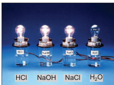
Fig. 20. Determinarea capacității soluțiilor apoase și a apei de a conduce curentul electric
