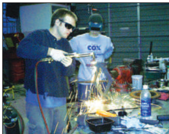
Fig. 67. Tăierea metalului cu ajutorul lămpii cu acetilenă
