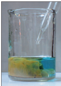
Fig. 31. Reacția sulfatului de cupru(II) cu iodura de potasiu în soluție
